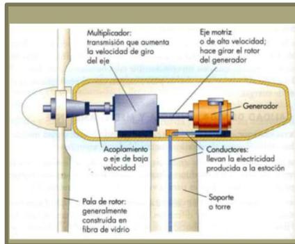
**Objetivo:** que el alumno utilice sus conocimientos de ingeniería para diseñar y fabricar un generador eólico de potencia variable autoregurable.
