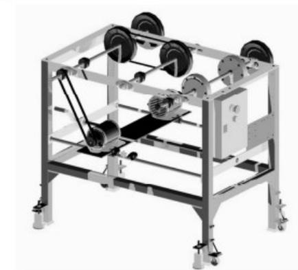
**Objetivo:** que el alumno utilice sus conocimientos de ingeniería para el diseño y fabricación de un banco didáctico que sirva para el análisis de vibraciones.
